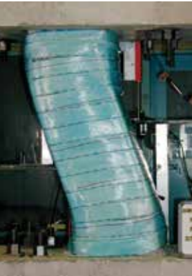
SRF工法で補強した柱の上下に大きな変位を与えた実験です。柱は破壊することなく元の形に戻ることが確認されました。
